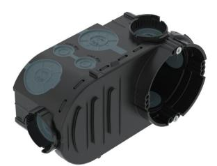
Caixa de eletrónica de encastrar com espaço de ligação adicional e entradas de membrana herméticas, para utilização em alvenaria com uma profundidade de instalação de pelo menos 67 mm.
