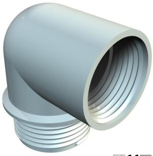
Ângulo de apoio com rosca PG interna e externa conforme a DIN 40430. O ângulo de apoio pode ser um bucim curvo se completado com 2 anéis de pressão 107/D em aço, um anel de vedação 107/A ou 107/B e um parafuso de pressão 107/E.
