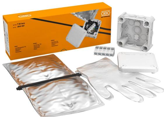
O tempo de processamento da resina fundida é de 40 minutos a 5°C e diminui, por ex. a 35°C, em 20 minutos. Quando armazenado num saco de alumínio e a uma temperatura ambiente de 15 a 30 °C, a resina fundida mantém-se por 24 meses.
