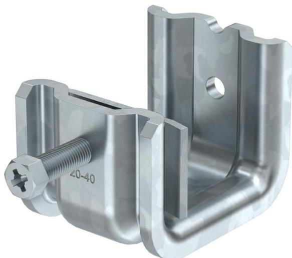
Este tipo de clip de suspensão é encaixado no apoio e fixo à viga ou ferro plano usando uma placa de pressão e um parafuso (M8). O parafuso hexagonal tem um WAF de 10 mm. No clip estão também incorporadas duas roscas M8 adicionais para, por exemplo, fixar um varão roscado.
