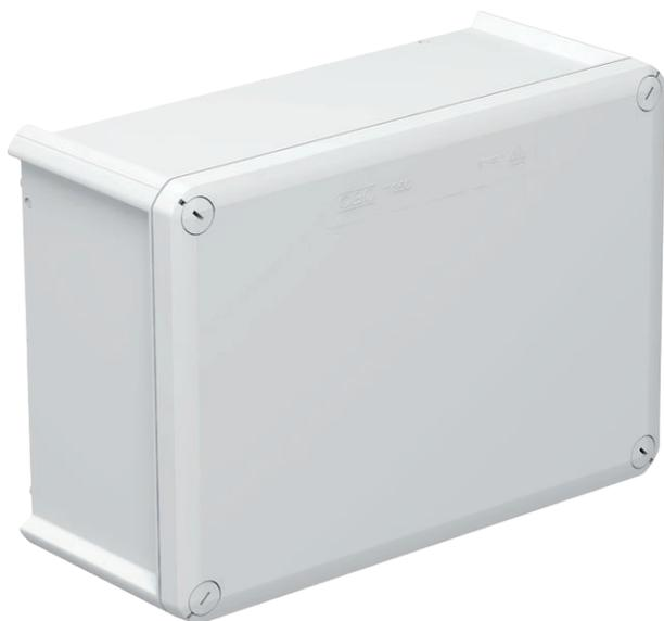
Caixa de derivação fechada para conectar cabos e condutas na área interior e áreas exteriores protegidas. Forma retangular sem entradas. Adequado para a montagem na parede e teto, a montagem em suportes para caixas de derivação e na base da caixa. Com opção de fixação interna e montagem através de parafusos nos cantos. Tampa com fecho rápido, pode ser selada a chumbo. Fabricado em materiais livres de halogéneo.
