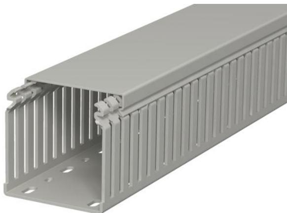
Calha de cablagem conforme a norma DIN EN 50085-2-3 inclui tampa e base perfurada para colocação horizontal e vertical de cabos e linhas elétricas no quadro de distribuição. Versão de calha DIN. A quebra das barras pode ocorrer sem ferramentas. A execução no pavimento é possível através de pontos de ruptura nominais. Testado de acordo com a DIN EN 50085-2-3. Comprimentos especiais disponíveis mediante pedido.
