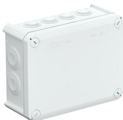
Caixa de derivação para conectar cabos em áreas interiores e áreas exteriores protegidas. Forma retangular com buçins cónicos nas laterais e entradas quebráveis na base. Adequado para a montagem na parede / teto e para a montagem em suportes para caixas de derivação. Com opção de fixação interna e montagem através de parafusos nos cantos. Tampa com fecho rápido, pode ser selada a chumbo. Versão resistente ao fio incandescente em polipropileno especial.
