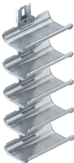
Porta-cabos para uma colocação de cabos simples e rápida em áreas de aplicação em que não possam ser montados sistemas de caminhos de cabos convencionais. Os porta-cabos possuem uma grande superfície de contacto e arestas exteriores arredondadas para a proteção dos cabos. Com base na norma VIN DVE 0298-300, não deve ser excedida a distância de apoio de 0,8 m.
