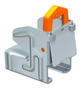
Clip de suspensão sem superfície roscada e com revestimento anticorrosivo, com mola de bloqueio e adequado para perfis do tipo CML3518 e CMS3518. Para a fixação rápida a perfis de aço na montagem de caminho de cabos, abraçadeiras BBS, suspensões para luminárias ou outros. Um sistema completo é composto por 2 clips de suspensão e uma peça de perfil C de qualquer comprimento, bem como 2 topos de proteção.
