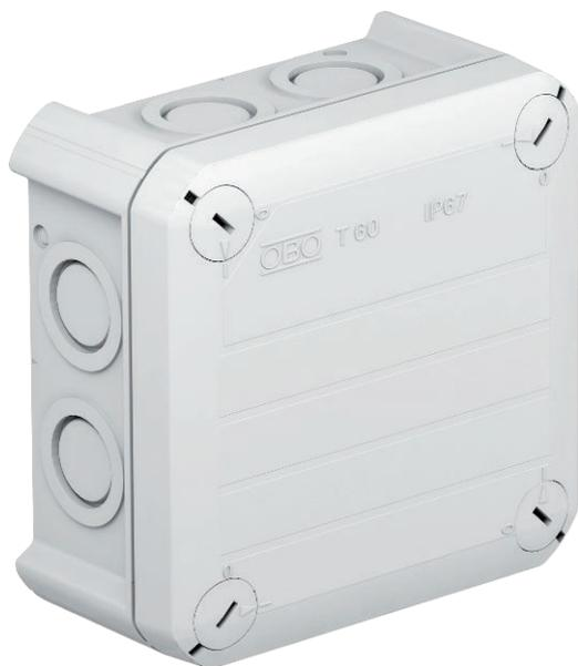
Caixa de derivação para conectar cabos em áreas interiores e áreas exteriores protegidas. Forma quadrada com entradas quebráveis nas laterais e entradas quebráveis na base. Adequado para a montagem na parede / teto e para a montagem em suportes para caixas de derivação. Com opção de fixação interna e montagem através de parafusos nos cantos. Com tampa de aperto fixa. Fabricado em materiais livres de halogéneo.
