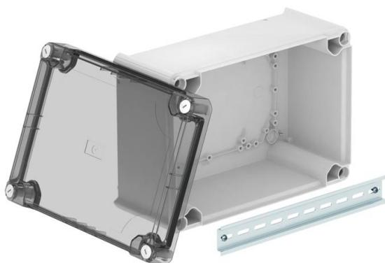
Caixa de derivação fechada para conectar cabos e condutas na área interior e áreas exteriores protegidas. Forma retangular sem entradas. Adequado para a montagem na parede e teto, a montagem em suportes para caixas de derivação e na base da caixa. Com opção de fixação interna e montagem através de parafusos nos cantos. Tampa alta, transparente, com fecho rápido, pode ser selada a chumbo. Fabricado em materiais livres de halogéneo.
