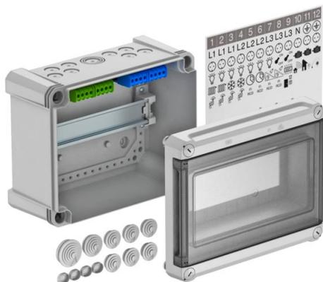
Quadro de distribuição com régua de bornes para montagem à superfície, para sub-distribuição de energia em área interior e área exterior protegida, de acordo com a IEC 439-3. Com calha DIN de 35 mm pré-montada. Tipo de proteção IP66 e grau de proteção IK06. Tampa transparente para aparafusar, com recorte.
