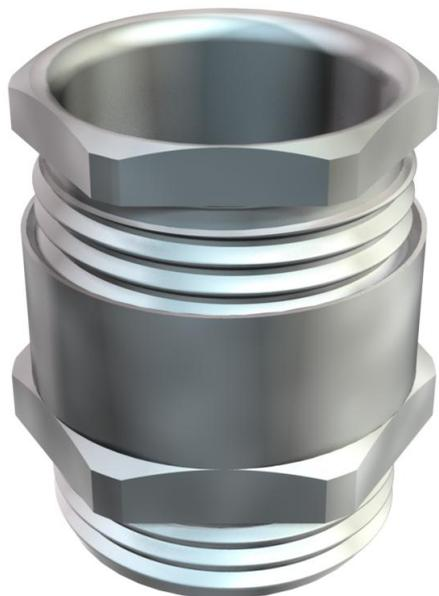
Bucim com peça intermédia sextavada, modelo C4 conforme a DIN 46320, com rosca métrica conforme a DIN EN 60423 ou ISO 68. Anel de pressão em aço, galvanizado a zinco e passivado de forma transparente. Anel de vedação em NR/SBR.
