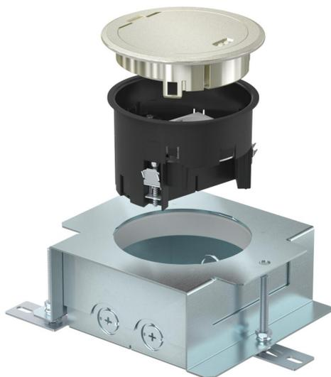
Tampa redonda GES R2 com tampa basculante, estrutura de proteção do pavimento e caixa de betonilha UD GES R2 para montagem em chão de betonilha em áreas interiores. Tampa de encastramento com uma tomada Schuko dupla com alvéolos inclinados a 33°. Lateralmente, perto da tomada existe espaço para instalar, opcionalmente, até 2 conectores de dados. No estado fechado, a tampa pode ser limpa a húmido. A profundidade mínima de montagem é de 85 mm. Superfície niquelada.
