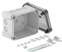
Caixa de derivação com calha DIN para conectar cabos e tubos em áreas interiores e exteriores. Forma retangular com entradas quebráveis. Adequado para montagem na parede e teto com opção para fixação externa ou montagem através de parafusos nos cantos. Particularmente resistente ao impacto com IK09. Tampa transparente com fecho rápido, pode ser selada a chumbo. Fabricado em materiais livres halogéneo e resistentes ao UV.
