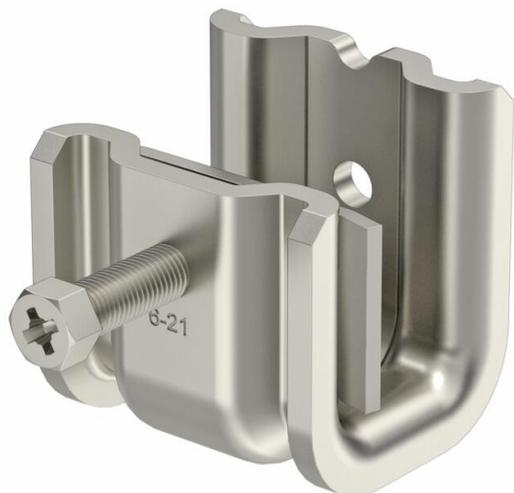
Este tipo de clip de suspensão é encaixado no apoio e fixo à viga ou ferro plano usando uma placa de pressão e um parafuso (M8). O parafuso hexagonal tem um WAF de 10 mm. No clip estão também incorporadas duas roscas M6 adicionais para, por exemplo, fixar um varão roscado.
