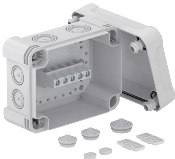
Caixa de derivação com régua de bornes para conectar cabos e tubos em áreas interiores e exteriores. Forma retangular com entradas quebráveis. Adequado para montagem na parede e teto com opção para fixação externa ou montagem através de parafusos nos cantos. Particularmente resistente ao impacto com IK09. Tampa com fecho rápido, pode ser selada a chumbo. Fabricado em materiais livres halogéneo e resistentes ao UV. Inclui régua de bornes, 5 polos.
