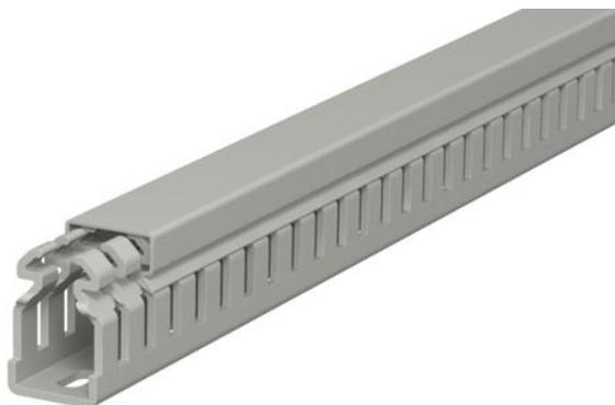
Calha de cablagem conforme a norma DIN EN 50085-2-3 inclui tampa e base perfurada para colocação horizontal e vertical de cabos e linhas elétricas no quadro de distribuição. Versão de calha DIN. A quebra das barras pode ocorrer sem ferramentas. A execução no pavimento é possível através de pontos de ruptura nominais. Testado de acordo com a DIN EN 50085-2-3. Comprimentos especiais disponíveis mediante pedido.
