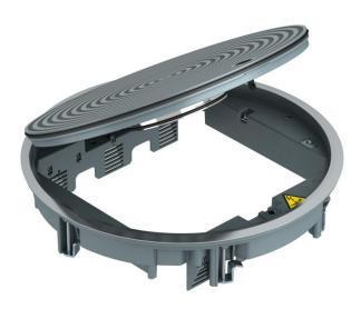
Tampa de encastramento com tubo periscópio para pavimentos tratados a húmido para até 12 aparelhos Modul 45 em 3 suportes universais UT4, utilização em sistemas de chão e calhas de pavimento em interiores. Podem ser utilizados até 9 aparelhos de instalação com placa central 50. Tampa com tubo para pavimento de limpeza a húmido, 3 vias, para a instalação de suportes de aparelhos MT9. Podem ser instalados 3 placas de suporte APMT5
