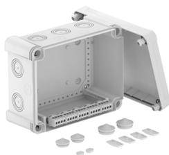
Caixa de derivação com régua de bornes para conectar cabos e tubos em áreas interiores e exteriores. Forma retangular com entradas quebráveis. Adequado para montagem na parede e teto com opção para fixação externa ou montagem através de parafusos nos cantos. Particularmente resistente ao impacto com IK09. Tampa com fecho rápido, pode ser selada a chumbo. Fabricado em materiais livres halogéneo e resistentes ao UV. Inclui bornes.
